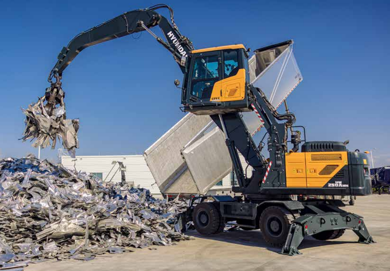
SAVM: veilig gezichtsveld in alle richtingen dankzij tien verschillende weergaven, waaronder 3D-vogelperspectief en 2D/4-kanaalsweergave.
